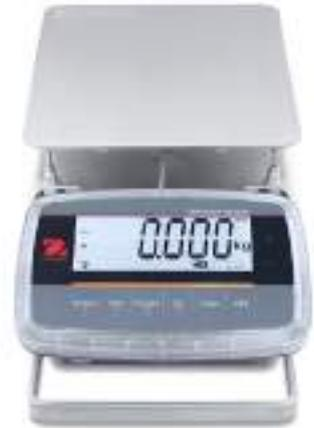
La Defender 6000 è in grado di resistere a lavaggi intensivi in ambienti di lavorazione e confezionamento grazie al grado di protezione contro immersione IP68/ambienti umidi IP69K, alla base in acciaio inossidabile 316 e alla cella di carico sigillata ermeticamente.
